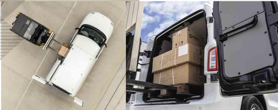
Das Be- und Entladen wird durch die 1.128 mm breite Öffnung der Seitentür und die beiden Hecktüren erleichtert.
